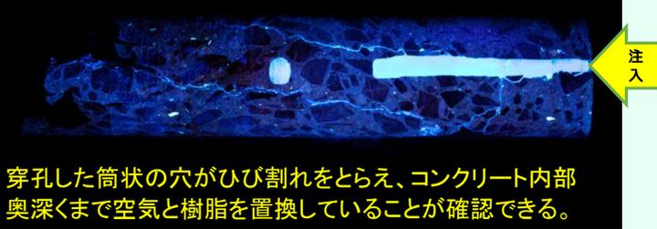
穿孔した筒状の穴がひび割れをとらえ、コンクリート内部奥深くまで空気と樹脂を置換していることが確認できる。
