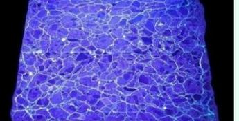
ASR模擬試験体注入実験
