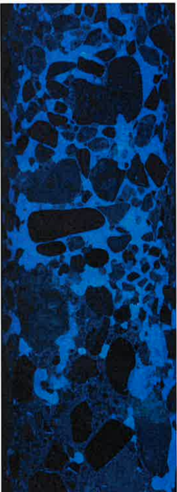
ブラックライトにより注入された樹脂が確認できます
